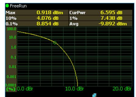
Шумоподобные сигналы подвергаются статистическому анализу. Средняя мощность, в случае представления сигналов с помощью CCDF, служит ориентиром, в то время как график показывает распределение более низких уровней мощности.
