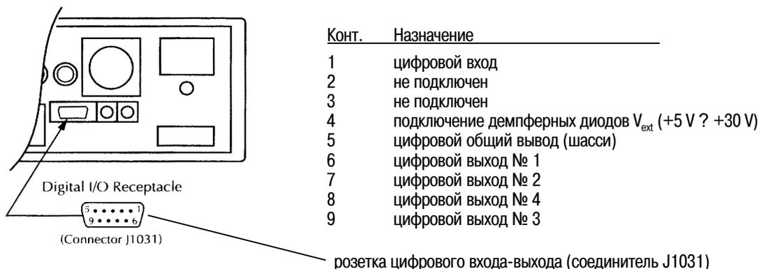
Рис. 51 Порт цифрового входа-выхода
