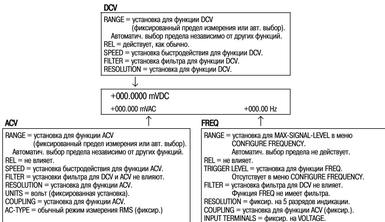
Рис. 13 Комплексная индикация при измерении постоянного напряжения
