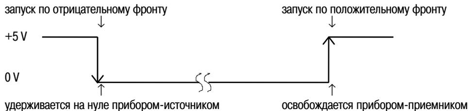
Рис. 39 Параметры импульсов запуска Trigger Link в полусинхронном режиме
