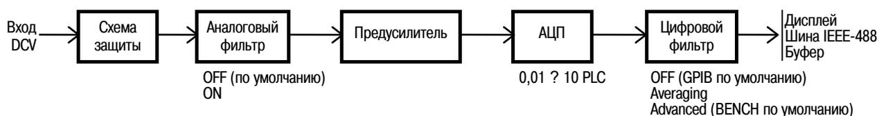
Рис. 45 Упрощенная блок-схема мультиметра типа 2001 (вход DCV)
