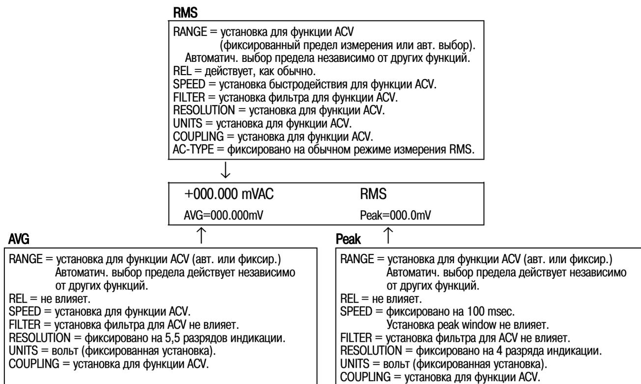
Рис. 14 Комплексная индикация при измерении переменного напряжения (продолжение)
