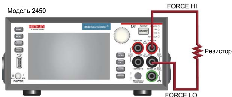
Рисунок 16: Подключение к разъемам на передней панели модели 2450 по двухпроводной схеме
