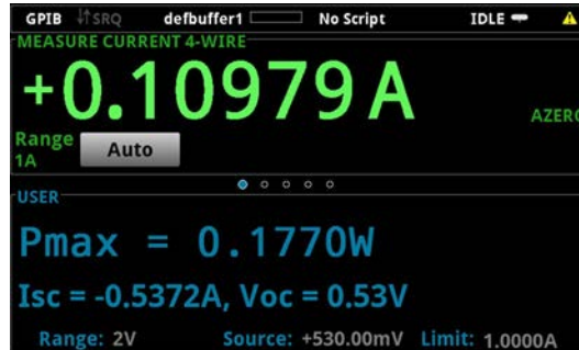
Рисунок 47: Результаты снятия ВАХ элемента солнечной батареи на дополнительном экране USER
