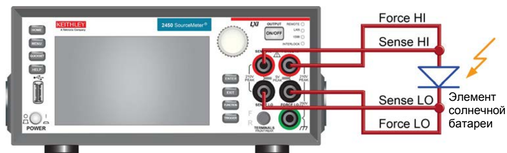
Рисунок 44: Подключение к передней панели модели 2450 по четырехпроводной схеме
