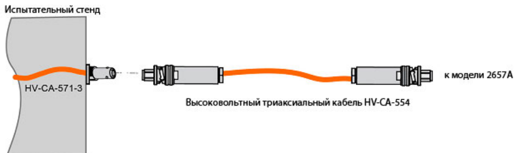
Рисунок 7: Подключение к пользовательскому испытательному стенду с помощью кабельной сборки HV-CA-571-3
