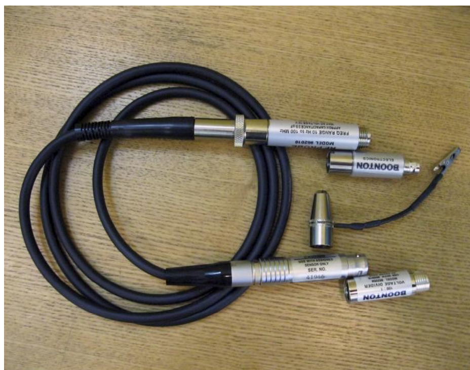
Рисунок 3 – Измерительный зонд, делитель, проходная нагрузка, щуп
