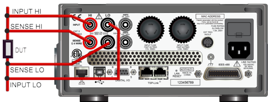
Рисунок 37: Подключение по четырехпроводной схеме к разъемам на передней панели DMM7510
