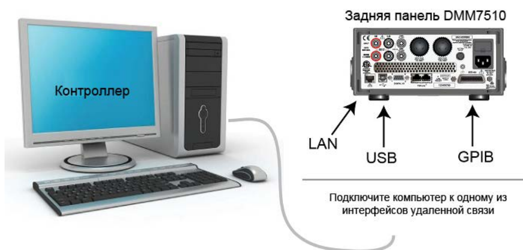
Рисунок 12: Схема подключения модели DMM7510 к интерфейсам удаленной связи
