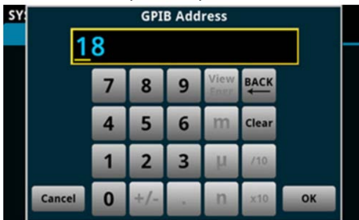
Рисунок 2: Клавишное поле на экране на передней панели для ввода адреса GPIB
