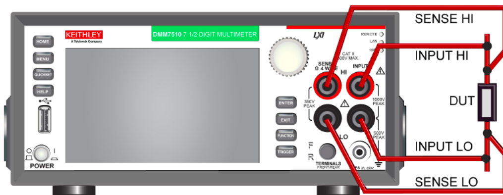
Рисунок 37: Подключение по четырехпроводной схеме к разъемам на передней панели DMM7510
