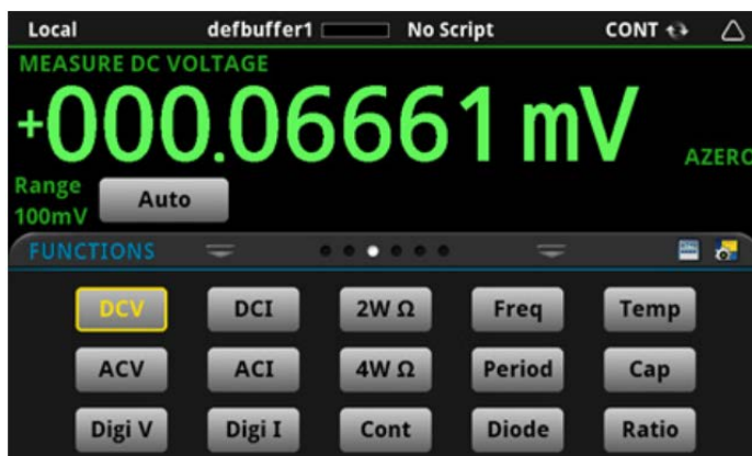
Рисунок 5: Интерактивный дополнительный экран FUNCTIONS
