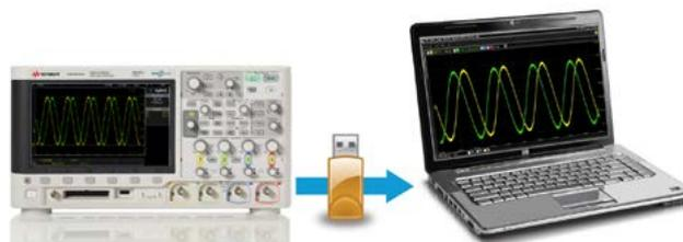
Просмотр и анализ осциллограмм можно выполнять на ПК, удаленном от осциллографа и исследуемого оборудования
