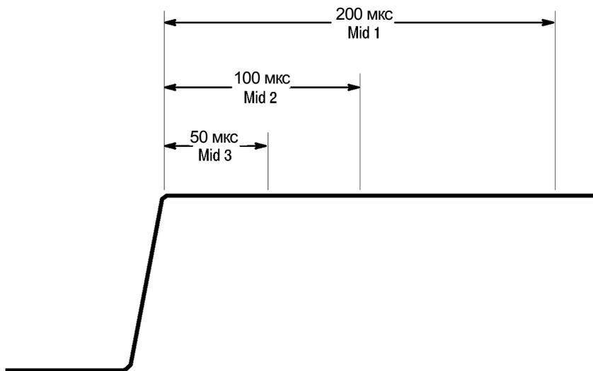
Рисунок 1-6: Зоны, подверженные воздействию компенсационных регулировок
