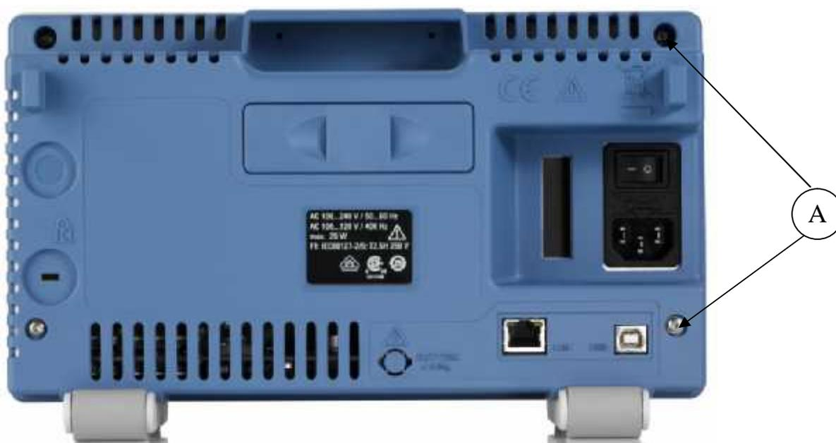
Рисунок 2 - Схема пломбировки от несанкционированного доступа (А)
