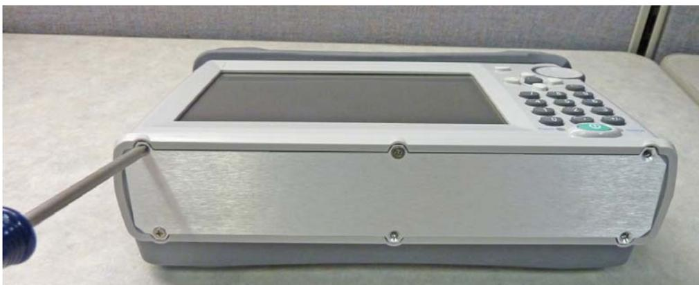
Рисунок 9-2. Снятие крышки аккумуляторного отсека
