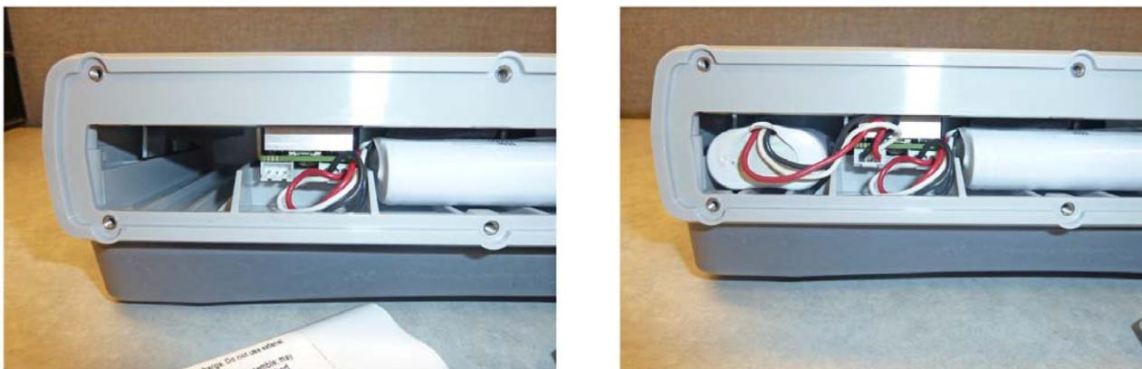
**Рисунок 9-4.** Установка второго аккумулятора
