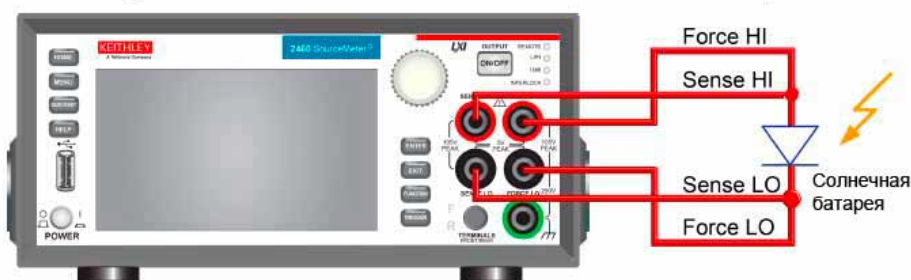
Рисунок 43: Подключение к разъемам на передней панели модели 2460 по четырехпроводной схеме
