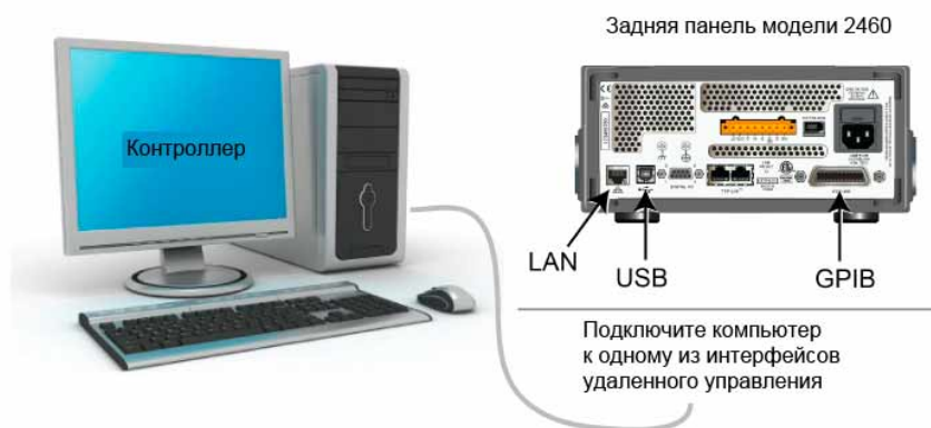
Рисунок 31: Схема подключения модели 2460 к интерфейсам удаленной связи
