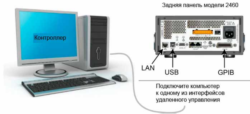
Рисунок 18: Схема подключения модели 2460 к интерфейсам удаленной связи
