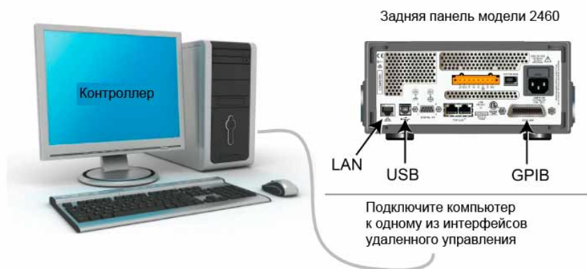
Рисунок 28: Схема подключения модели 2460 к интерфейсам удаленной связи
