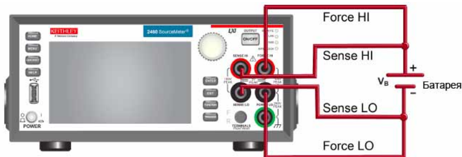
Рисунок 26: Подключение к разъемам на передней панели модели 2460 для заряда-разряда батареи
