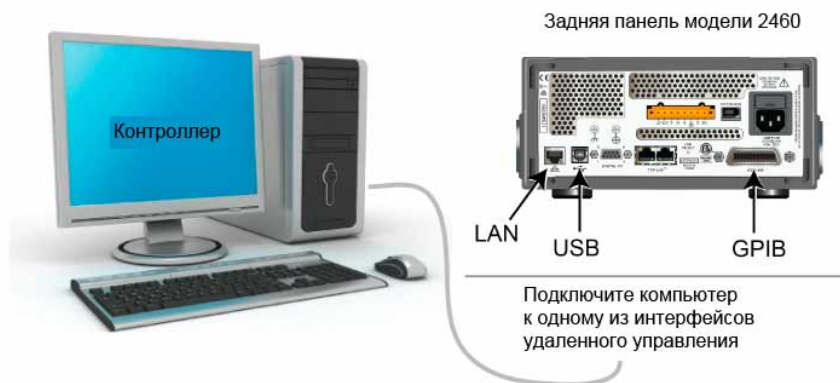
Рисунок 41: Схема подключения модели 2460 к интерфейсам удаленной связи
