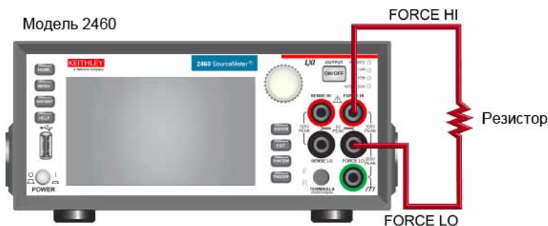
Рисунок 17: Подключение к разъемам на передней панели модели 2460 по двухпроводной схеме
