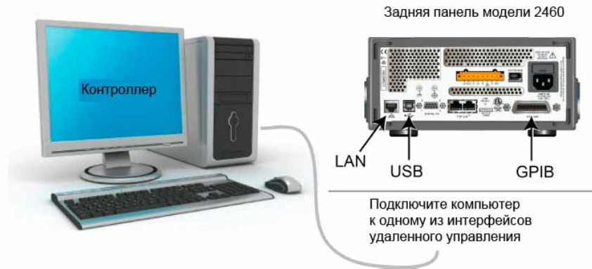
Рисунок 48: Схема подключения модели 2460 к интерфейсам удаленной связи
