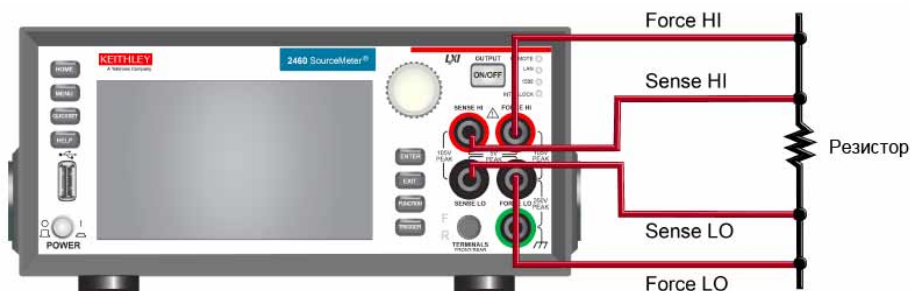
Рисунок 50: Подключение к разъемам на передней панели модели 2460 по четырехпроводной схеме
