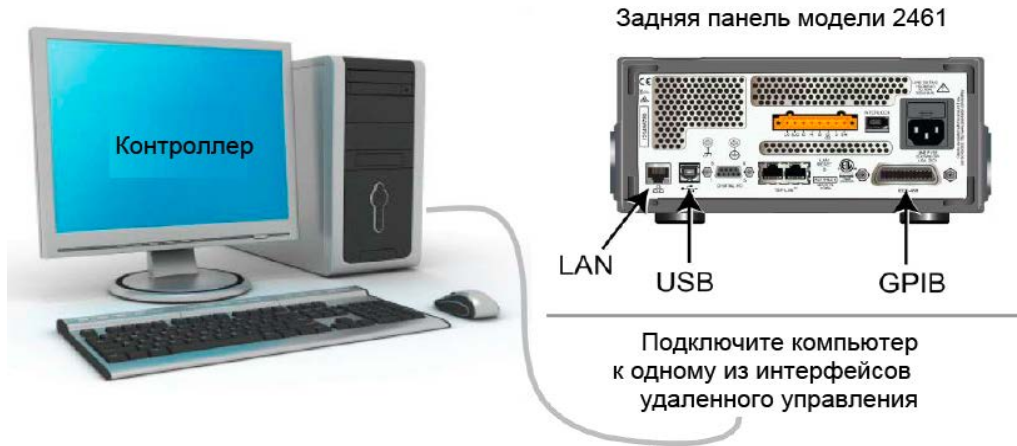
Рисунок 55: Схема подключения модели 2461 к интерфейсам удаленной связи
