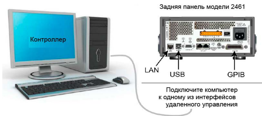
Рисунок 20: Схема подключения модели 2461 к интерфейсам удаленной связи
