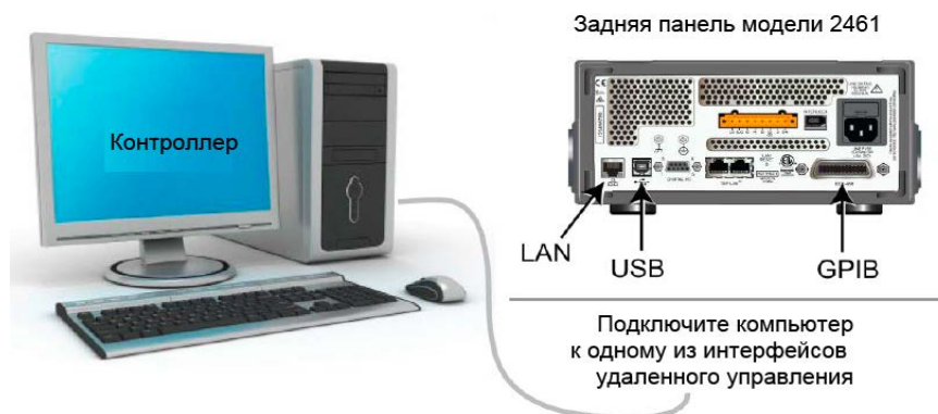
Рисунок 41: Схема подключения модели 2461 к интерфейсам удаленной связи
