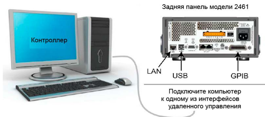
Рисунок 30: Схема подключения модели 2461 к интерфейсам удаленной связи
