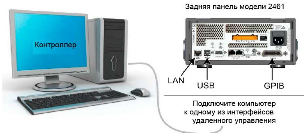
Рисунок 48: Схема подключения модели 2461 к интерфейсам удаленной связи
