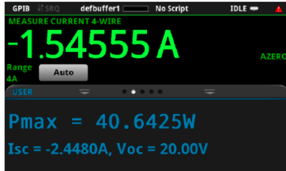
Рисунок 46: Результаты снятия ВАХ элемента солнечной батареи на дополнительном экране USER
