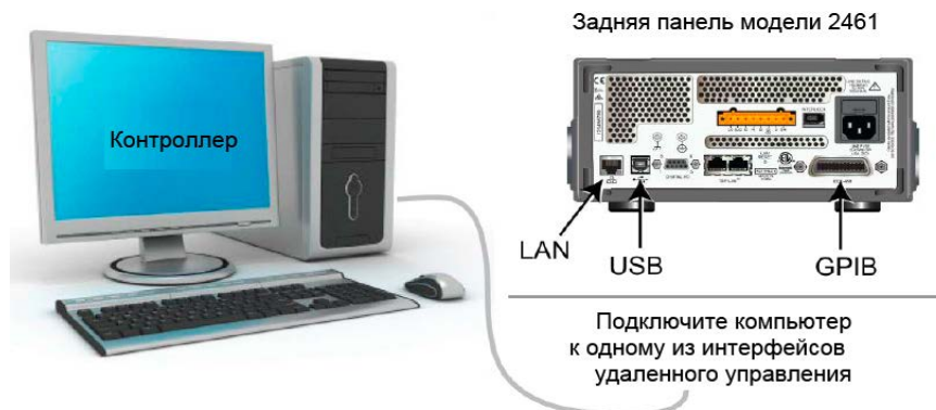
Рисунок 33: Схема подключения модели 2461 к интерфейсам удаленной связи
