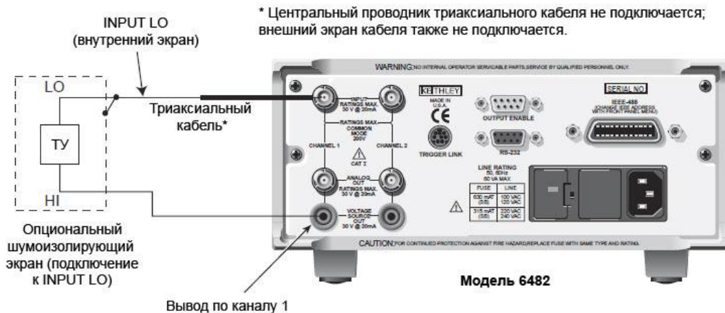
Рисунок 2-4 Схема подключения для воспроизведения напряжения
