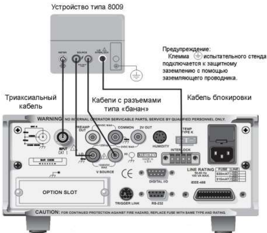
Рис. 3-4 Измерение удельного сопротивления
