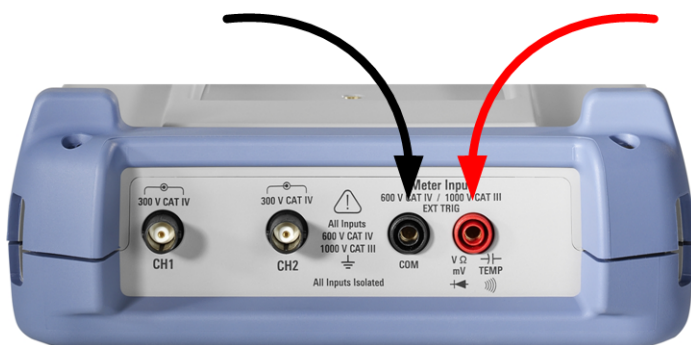
Рис. 4-1: Входы мультиметра для подключения щупов
