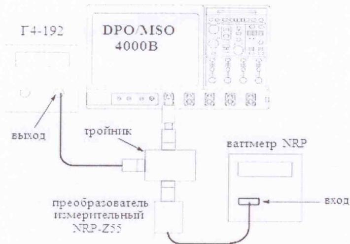
Рисунок 2- Схема определения полосы пропускания осциллографа
