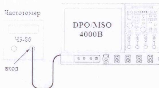
Рисунок 3– Схема определения диапазона установки коэффициентов развертки и погрешности частоты опорного генератора
