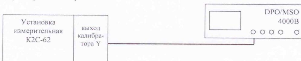
Рисунок 1 - Схема определения работоспособности осциллографа, диапазона и относительной погрешности установки коэффициентов отклонения
