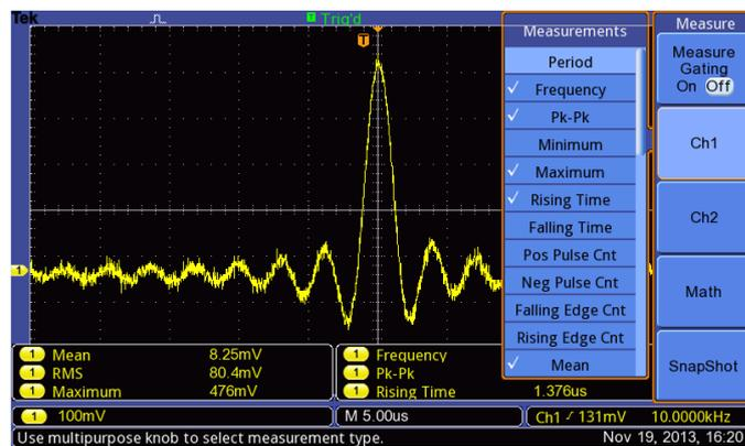
Быстрый анализ сигналов с помощью 34 стандартных видов автоматических измерений
