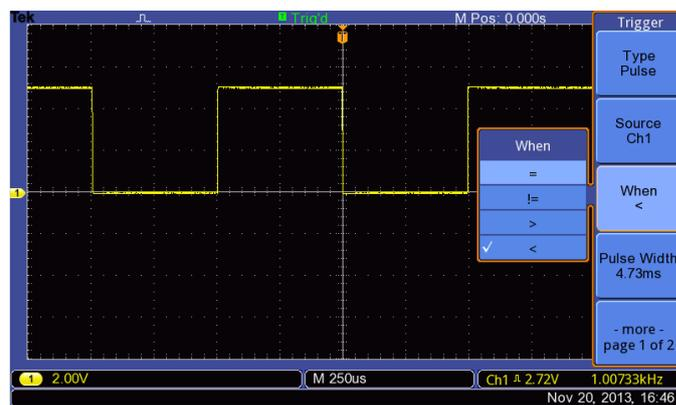
Применяя функцию запуска по длительности импульса, можно легко захватывать важные события.
