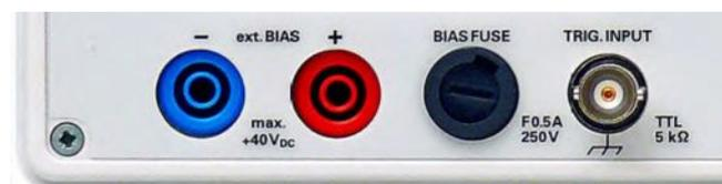
Рис. 4.2 – Задняя панель с сетевым предохранителем
