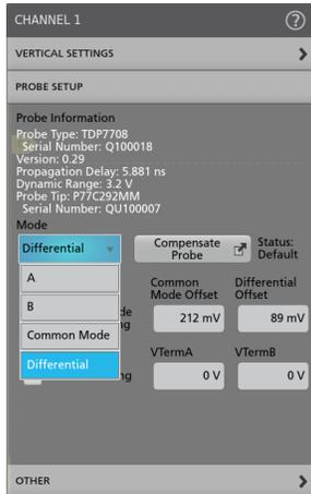
**Режим A – GND** используется для несимметричных измерений на входе пробника A. Вход заземления пробника подключается к наконечнику пробника и экрану главного кабеля. Режим A – GND предназначен для минимального соединения любого сигнала, присутствующего на входе B, в пределах характеристик изоляции пробника на входе A.
