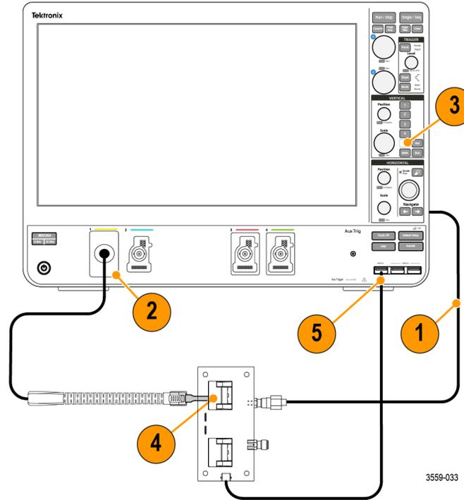
1. Соедините кабелем SMA источник сигнала, например выходной разъём генератора AFG, встроенного в осциллограф, с входом А на испытательном приспособлении.
