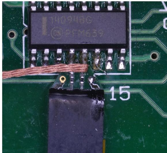
3. Если припой нельзя полностью удалить с входного межслойного соединения при креплении к контрольным точкам, можно покачать наконечник из стороны в сторону, оплавляя припой в межслойных соединениях. Поскольку провода обрезаются вровень с платой, этот метод позволяет постепенно отделить наконечник от проводов. После удаления наконечника с платы очистите межслойные соединения с помощью оплётки для выпайки, чтобы можно было повторно использовать наконечник.
