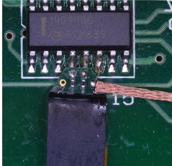
2. Удалите с помощью оплётки для выпайки лишний припой с входных межслойных соединений. Действуйте осторожно, стараясь не подносить оплётку для выпайки слишком близко к входным резисторам.
