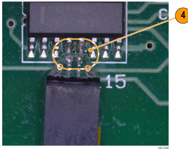
5. Прикрепите заземляющий провод для входа TriMode к пробнику P7700. Сначала нанесите припой на контрольную точку и ближайшее межслойное соединение заземления на паяном наконечнике.
