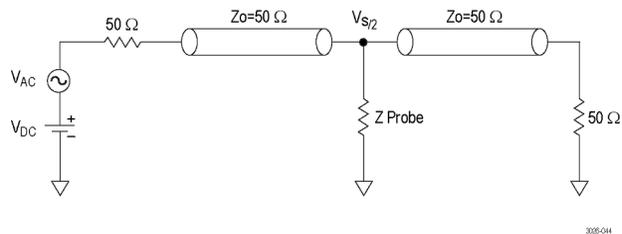
**Рис. 4: Конфигурация измерения припаиваемого наконечника**
