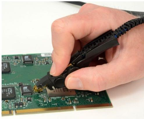
Поисковый наконечник – это принадлежность только для дифференциального пробника, но его также можно использовать для измерения эталонного заземления и несимметричных цепей. При измерении сигнала эталонного заземления подключите вход на стороне А (положительный) к измеряемому сигналу, а вход на стороне В (отрицательный) – к заземлению.
