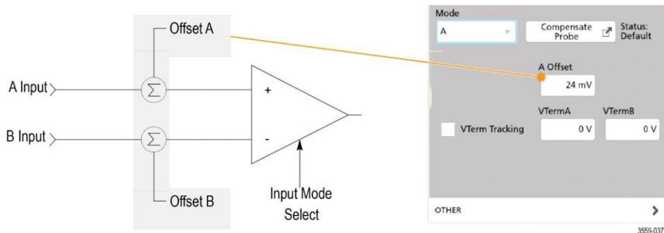
Рис. 1: Упрощённая модель входа пробника
