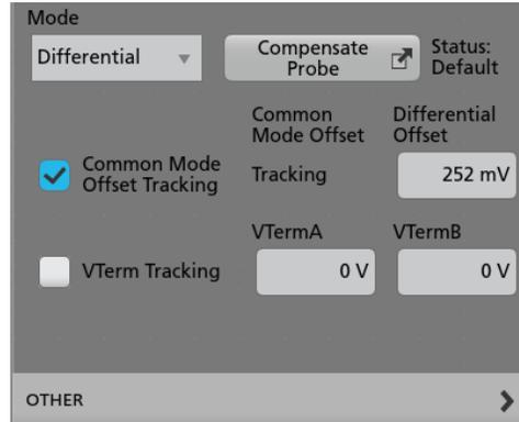
**Слежение за смещением дифференциального напряжения.** При выборе этого режима устанавливается слежение за Differential Mode Offset (Смещением дифференциального напряжения).
