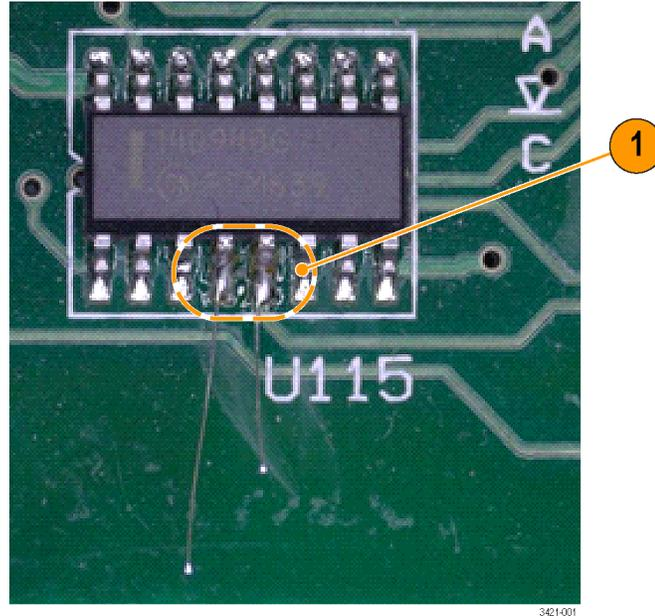
2. Наденьте наконечник на провода. Два средних межслойных соединения — это входы A(+) и B(-) наконечника.
