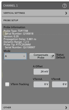
**Рис. 2:** панель настройки пробника
