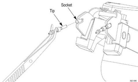
Вынув старый щуп, достаньте новый сменный щуп из упаковки в комплекте принадлежностей. Возьмите сменный щуп пинцетом и аккуратно вставьте в гнездо на передней части поискового наконечника.
