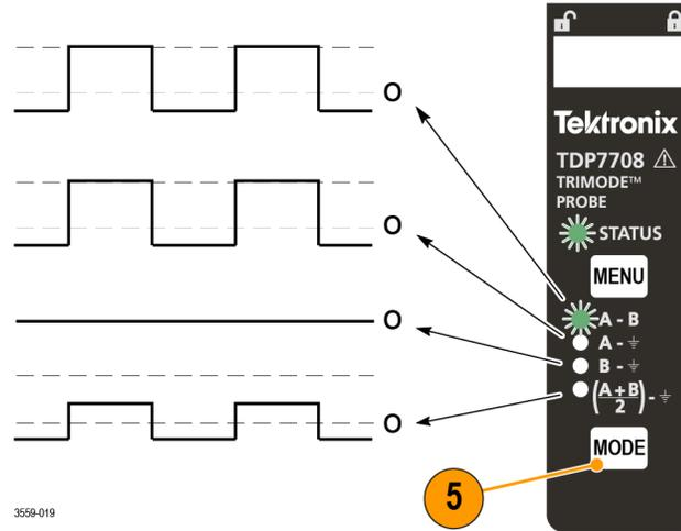
6. Отсоедините кабель SMA от входа A компенсатора и подключите его на вход B. Повторите описанные проверки осциллограмм. Измерения должны отличаться следующим образом:
