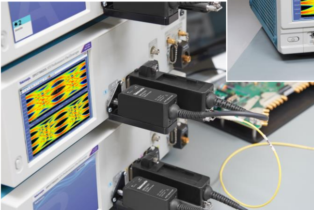
Оптические пробники серии DPO70E используют канал ATI 70 ГГц осциллографа серии DPO70000SX.
