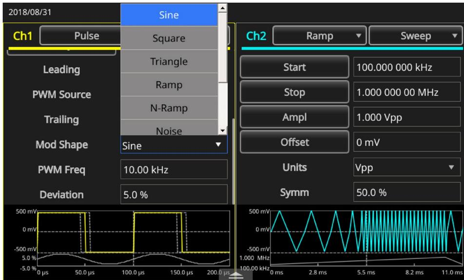
Рисунок 42: Настройки формы модуляции
