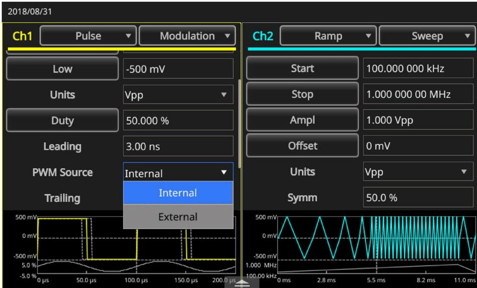
Рисунок 40: Настройки источника ШИМ
