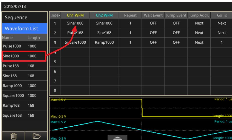
Рисунок 97: Перетягивание сигналов
