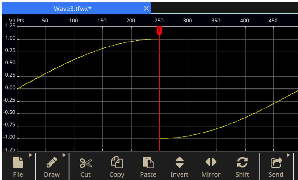
Рисунок 142: Инверсия сигнала в ArbBuilder
