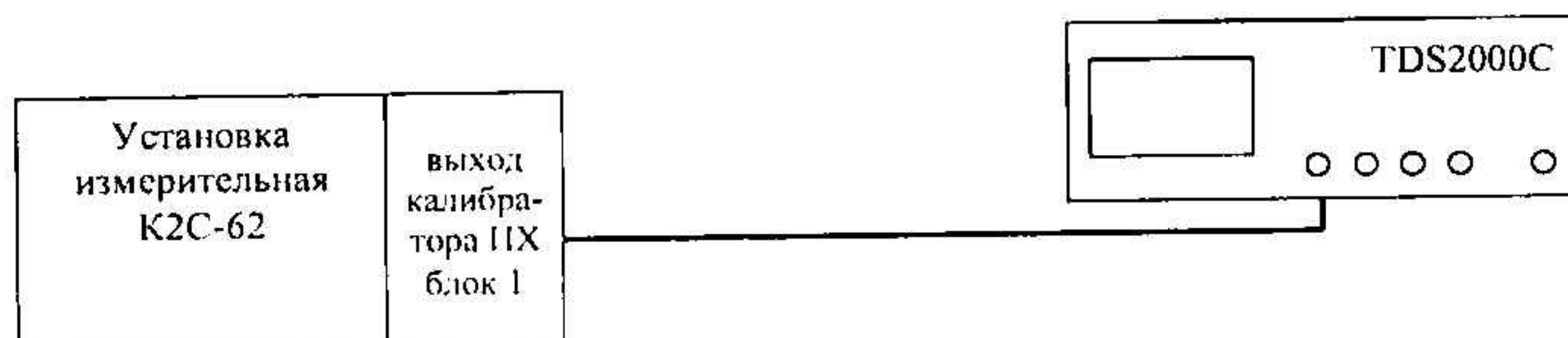
Рисунок 2- Схема определения полосы пропускания осциллографа
