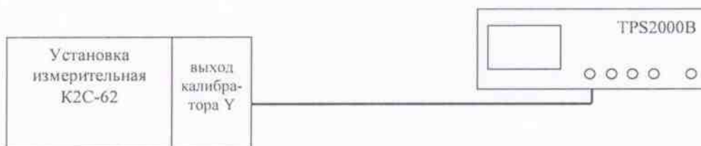
Рисунок 1 - Схема определения работоспособности осциллографа, диапазона и относительной погрешности установки коэффициентов отклонения
