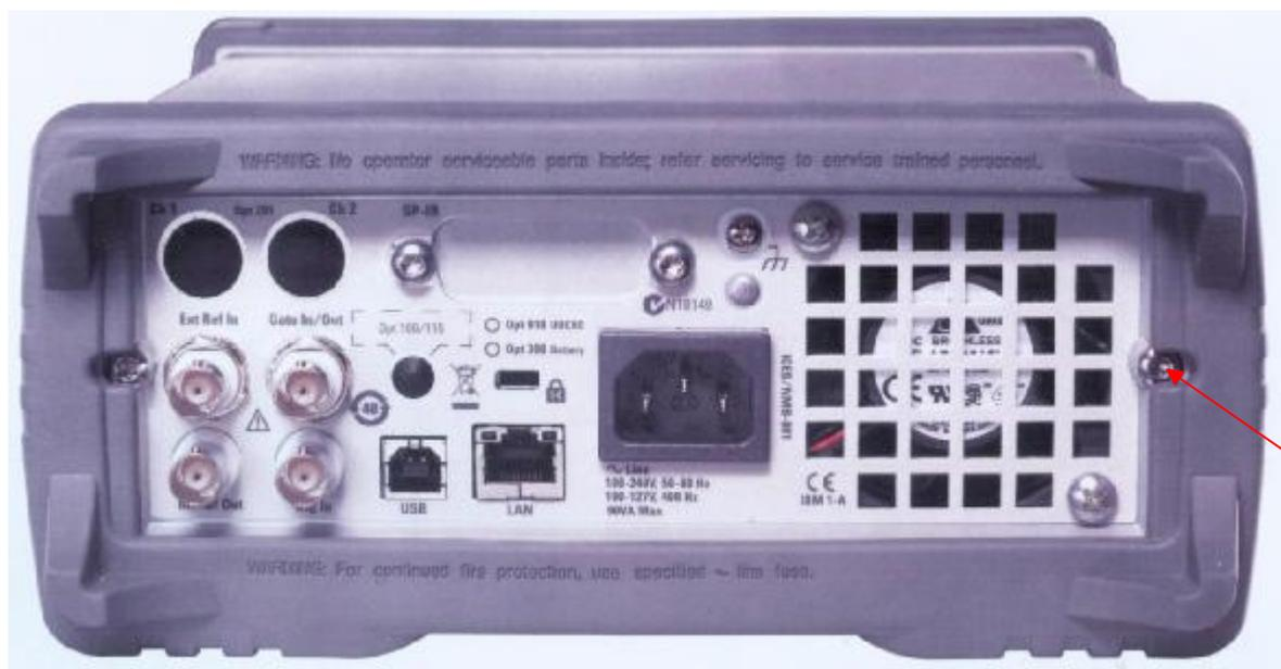
◆ - Место пломбировки от несанкционированного доступа
