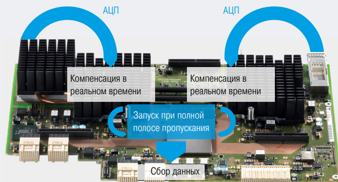
Плата запуска и компенсации цепей в реальном масштабе времени осциллографа R&S®RTP
