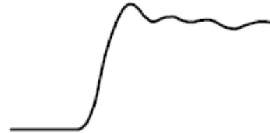
Длинный провод заземления
