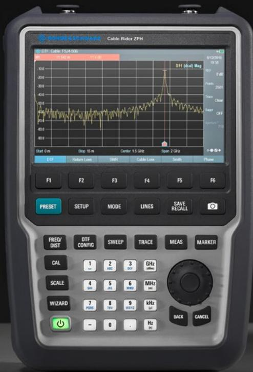
Благодаря малому времени загрузки и прогрева, а также высокой скорости измерений анализатор R&S® Cable Rider ZPH выдает результаты анализа без промедления. Можно заранее сформировать схемы измерения и задать предварительные настройки. Благодаря функции мастера измерений быстрые и точные измерения выполняются за один шаг. Протоколы измерений без труда создаются с помощью ПО R&S®InstrumentView.
