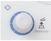
This knob can be used to select parameter item, adjust the value of the parameter and etc.
